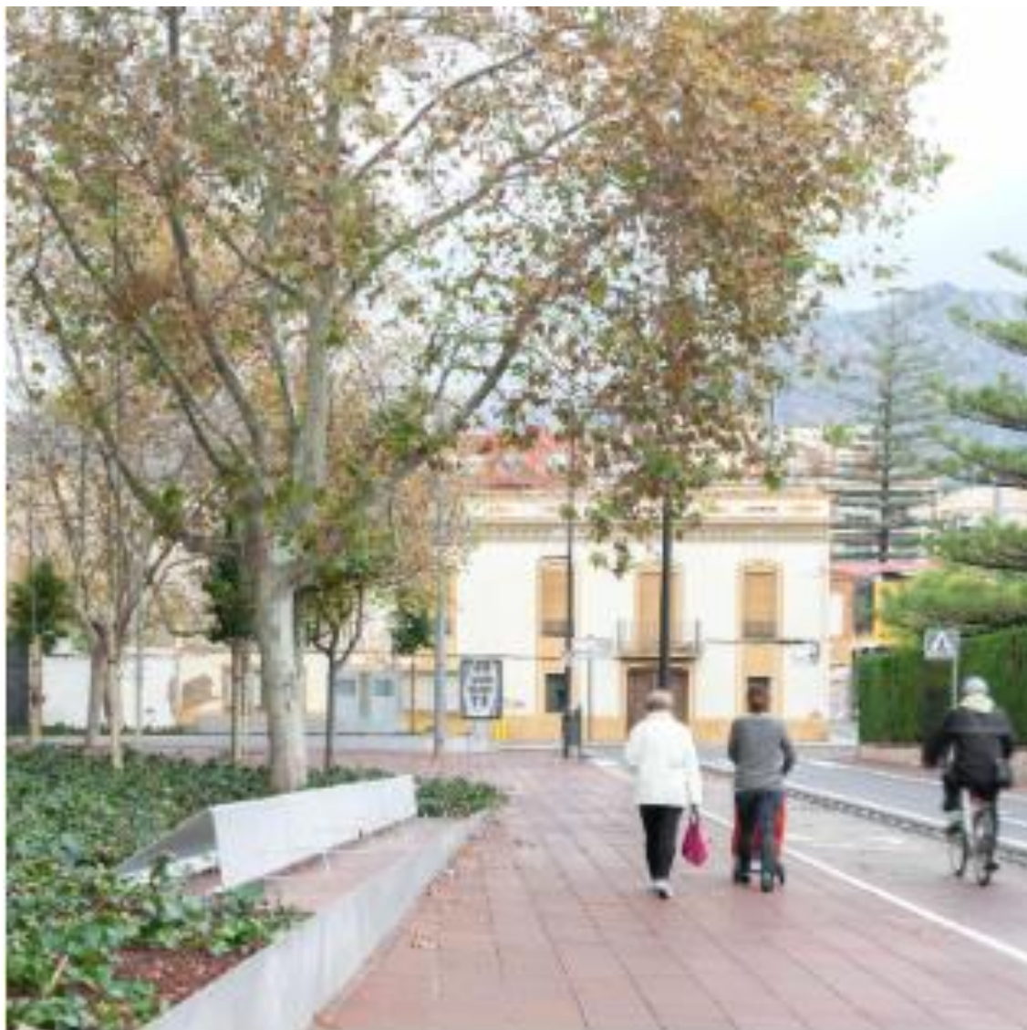
Pavimento cerâmico permeável instalado numa rua de tráfego ligeiro e pedonal em Benicàssim. Fonte: https://www.lifecersuds.eu/es/demostrador
